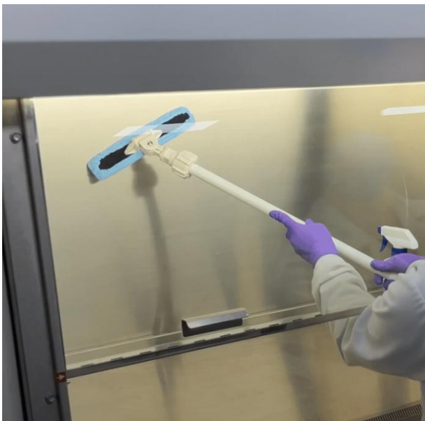
Figura 24: Uso de limpiador extensible para el interior de la CSB.
