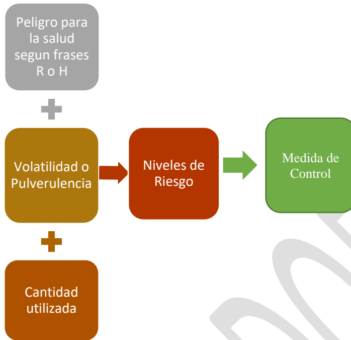
5267 Figura 14-1 Etapas utilizadas en la evaluación de riesgo para identificar medidas de control adecuadas
