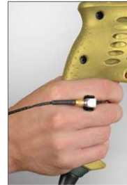
Figura 3.3 Acelerómetro triaxial para vibraciones mano-brazo con su respectivo adaptador
