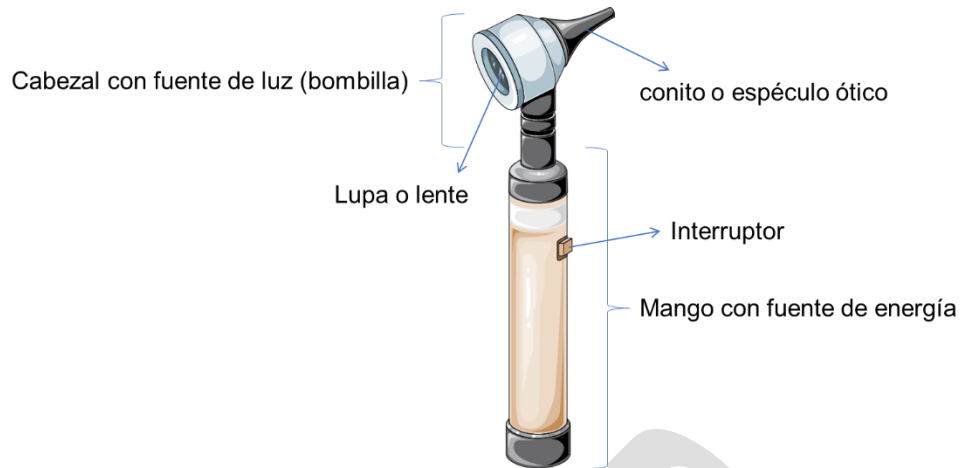
Figura 20-4. Diagrama de otoscopio de luz
