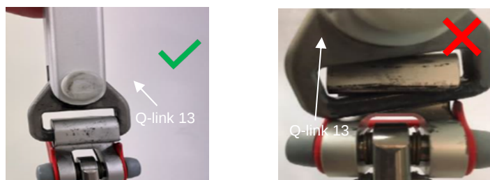
Figura 1. Conexión Correcta vs Conexión Incorrecta del Q-link 13 con el gancho de liberación rápida
