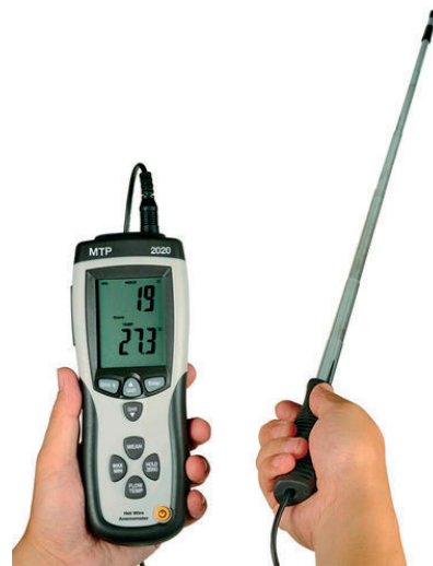
Figura N°3: Termoanemómetro (imagen de referencia)
