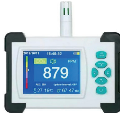
Figura N°7: Medidor de concentración de CO 2 (imagen de referencia)
