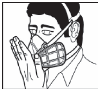
Prueba de Presión Positiva Máscara de Medio Rostro (Filtros con ajuste tipo bayoneta)
